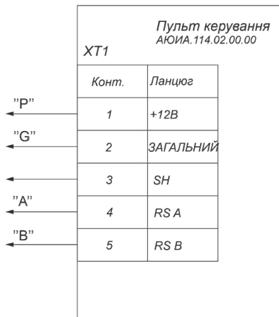
Рисунок Б.2 – Схема електрична підключення пульта керування АЮИА.114.02.00.00
