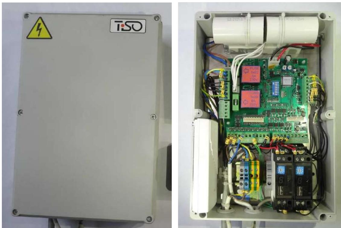
Рис. 1 - Блок управления блокиратором с внутренней минигидростанцией.
