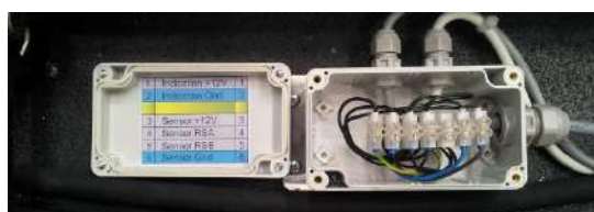
Рис. 5- Ревизионная коробка блокиратора с TX1. Blocker connection block и кабельными гермовводами.
