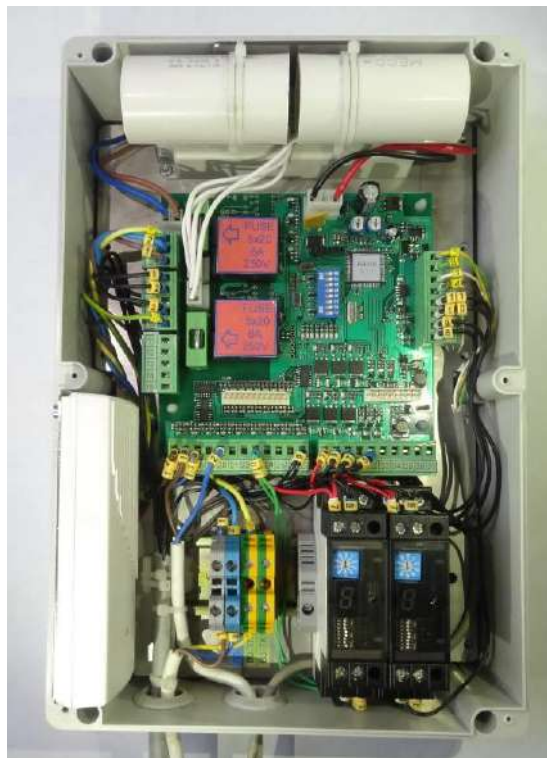
Рис. 1 - Блок управления блокиратором с внутренней минигидростанцией.
