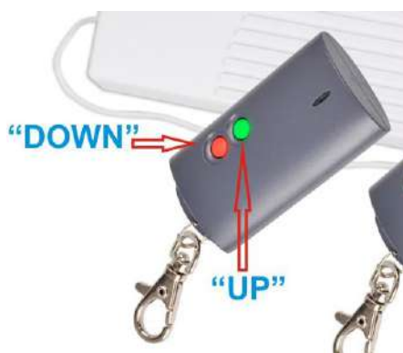
Рис. 14 - Радиобрелок управления блокиратором Satel RE-2K .
