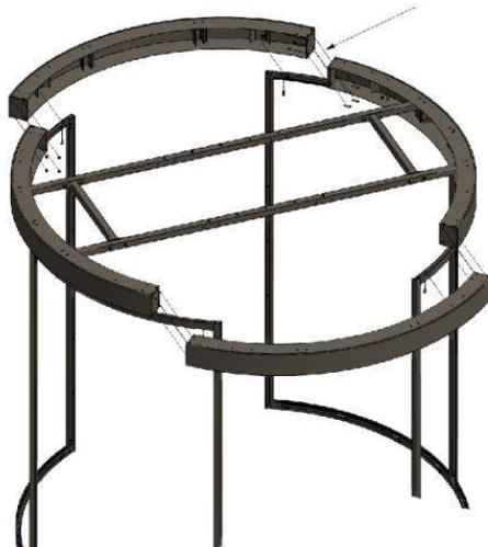
8) Закрепите входные сегментные короба с балками дополнительными перекладинами, устанавливая их в пазы, и перемычкой каркаса, соединяя винтами М8 заподлицо к ранее установленной перпендикулярно балкой, образуя устойчивый каркас крыши.
