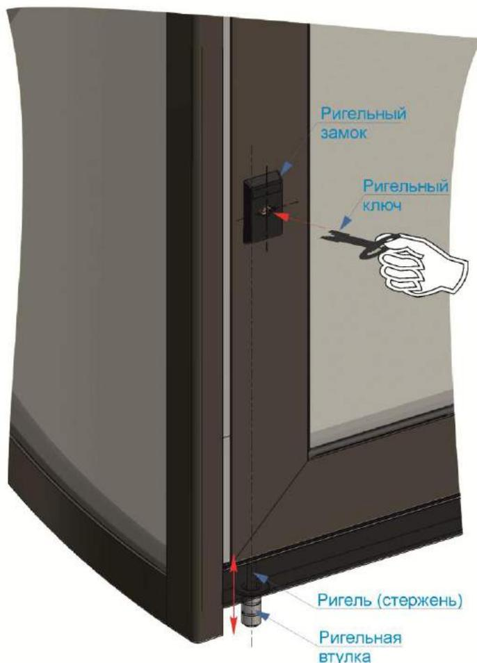
Дверь блокируется с помощью поворачивания ключа рукой
